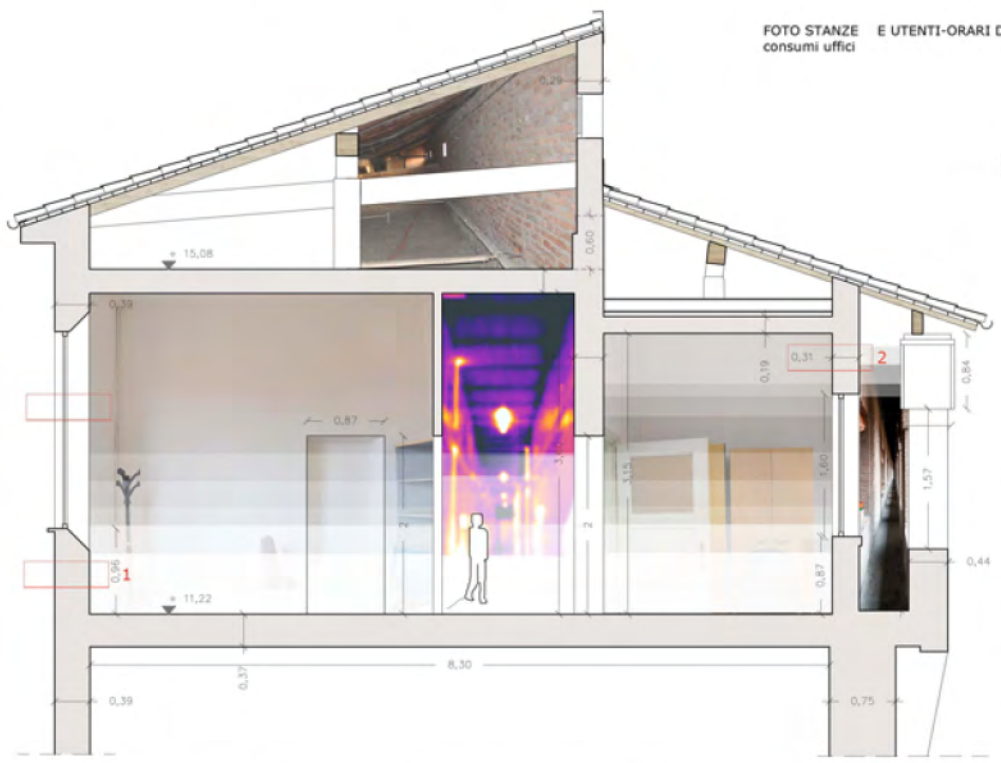
Fig n.1: CORRIDOIO, travature in latero-cemento perpendicolari alla facciata.
