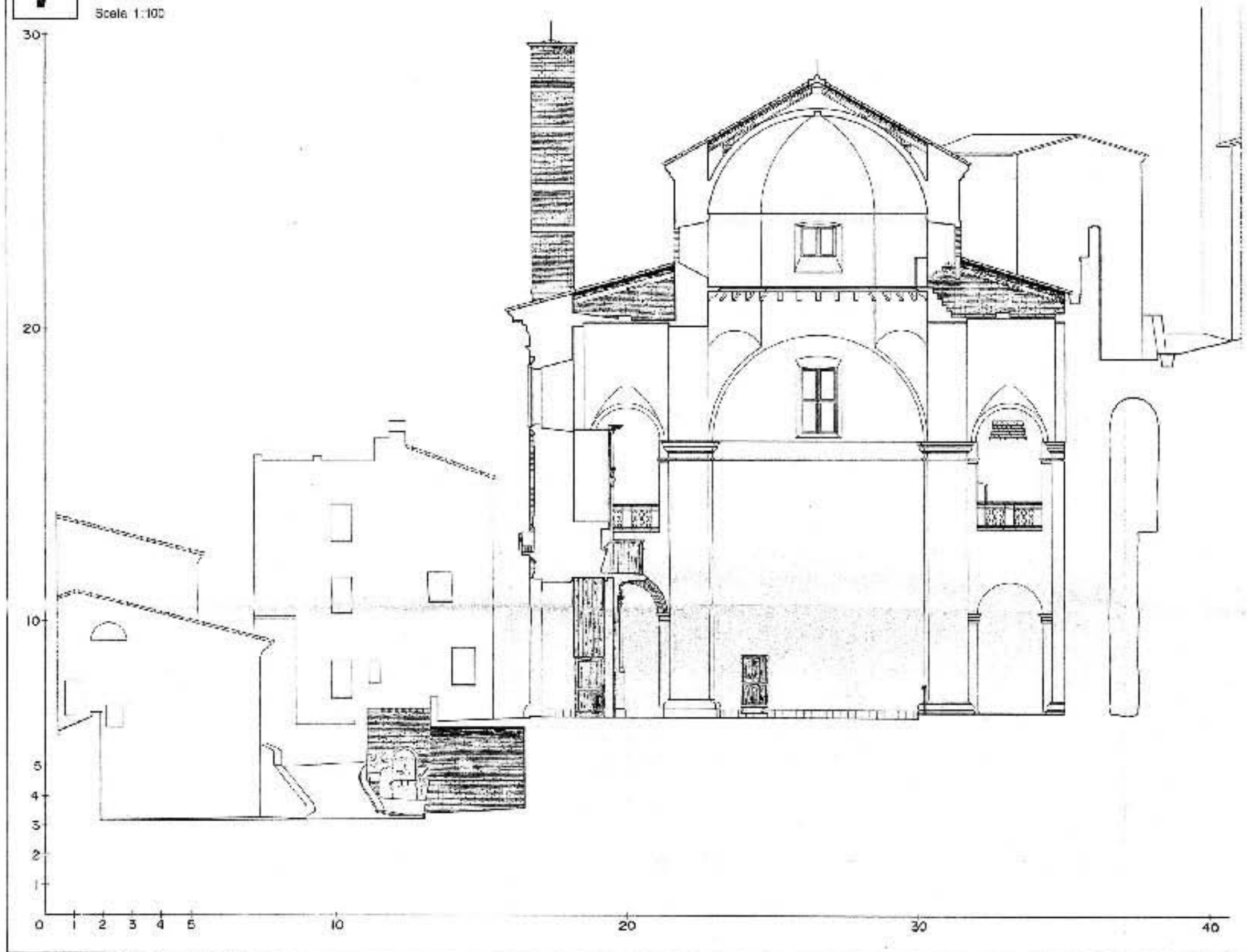
Tavola N - Grottoammare. Chiesa di Santa Lucia. Sezione Y - Y' (da POLICETTI 1991).
