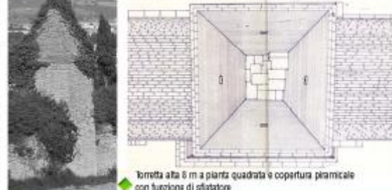
Torretta alta 6 m a pianta quadrata e copertura piramidale con funzione di sfiatore
