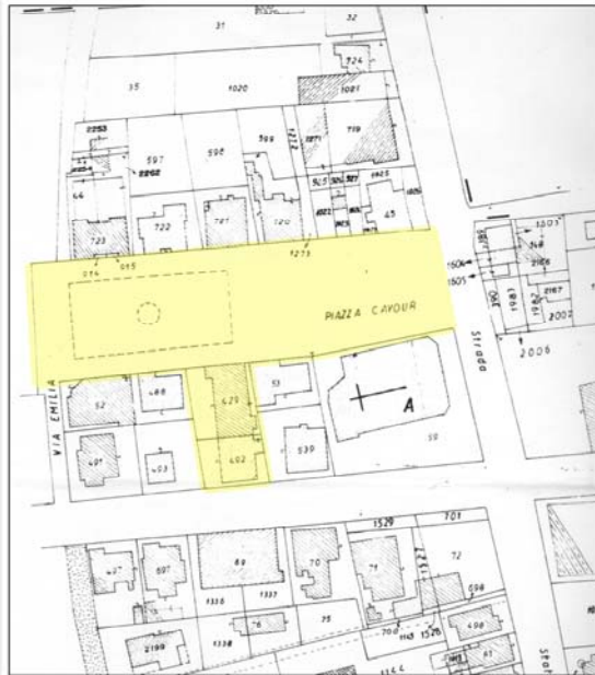
STRALCIO MAPPA CATASTALE scala 1:2.000 Dalla mappa catastale si evince che la sagoma del fabbricato risulta in parte differente dallo stato attuale.
