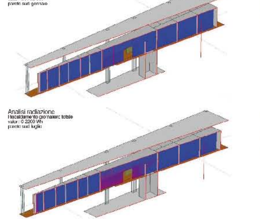
Analisi radiazione: Riscaldamento per radiazioni: valori 0-2500 Wh/m², gennaio
