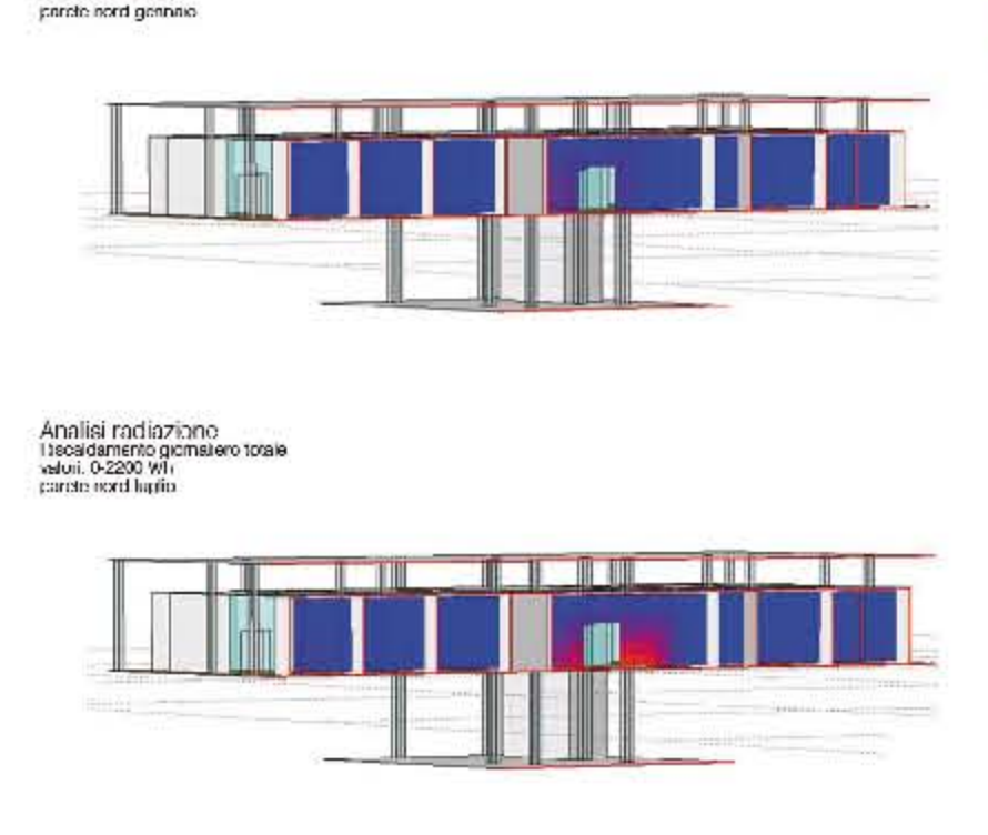
Analisi radiazione: Riscaldamento per radiazioni: valori 0-5000 Wh/m², gennaio
