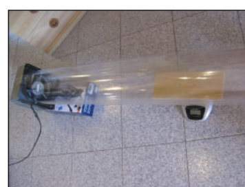
Primo prototipo di galleria del vento.
