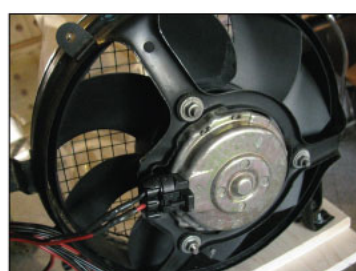
Ventola con motore alimentato a 12V.
