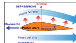
La differenza di pressione crea una forza chiamata portanza(o deportanza).
