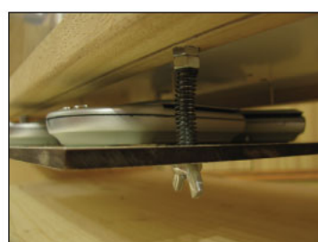
Scaffale con molla per evitare le vibrazioni.
