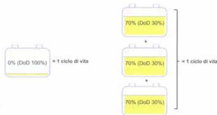
È molto importante sapere quale è la profondità di scarica di una batteria poiché il ciclo di scarica ha diversi effetti sulla batteria se compiuto al DoD 100% oppure al DoD 30% visto che i cicli completi al 100% affaticano moltissimo le batterie facendole durare anche il 60% in meno della vita stimata.
