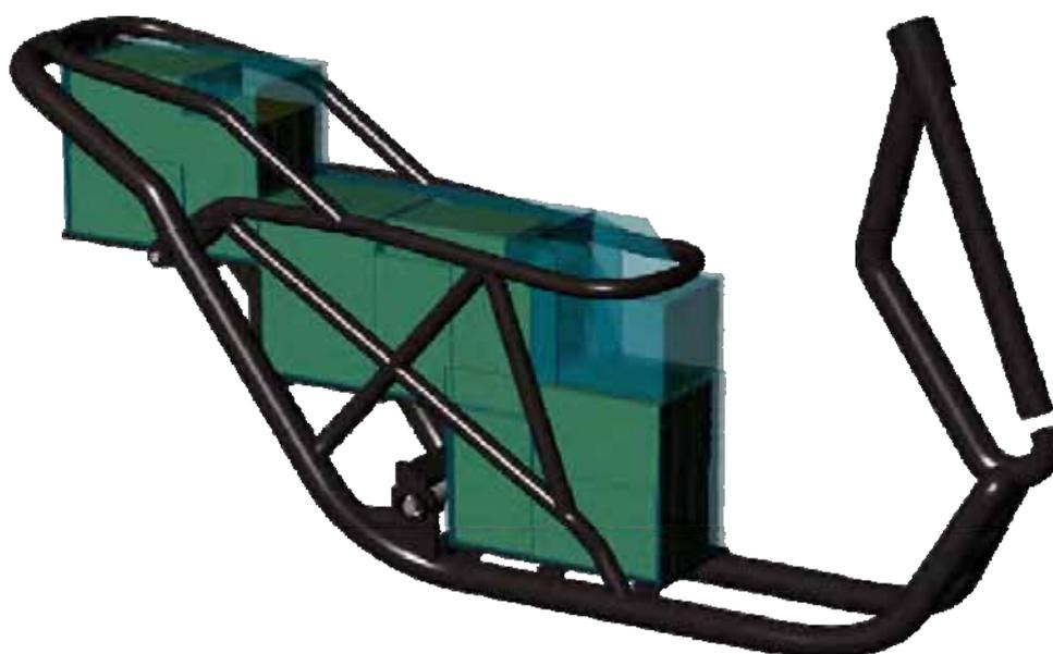
**Descrizione** Comprende il telaio in tubi curvati di acciaio al quale è bullonato un contenitore in materiale polimerico rivestito internamente per essere isolante e adatto a resistere al calore di esercizio oltre che ignifugo in caso di cortocircuito.
