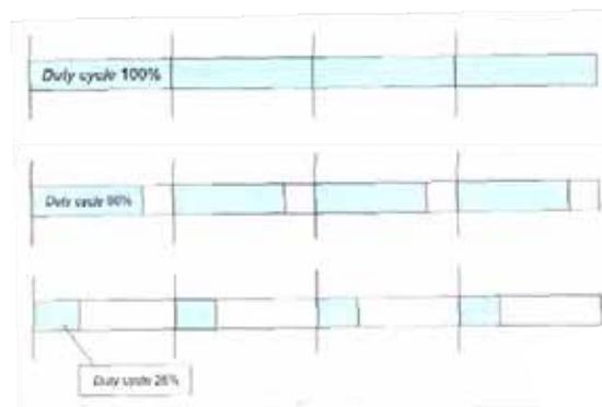
La regolazione della durata della spinta e della sua intensità è ciò di cui si occupa l'acceleratore di un mezzo elettrico che non è quindi collegato direttamente al motore ma alla centralina che a seconda dell'accelerazione decide se e quando aumentare il duty Cycle e quindi la corrente erogata al motore.
