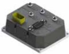
L'ESC è il regolatore di potenza ovvero fa da tramite tra la potenza immagazzinata nella batteria e la tensione a basso voltaggio che arriva dal circuito Arduino, dal quale vengono impartiti i comandi che devono essere tradotti affinché arrivino al motore sotto forma della corretta quantità di energia per eseguire azioni pianificate dal microcontrollore.
