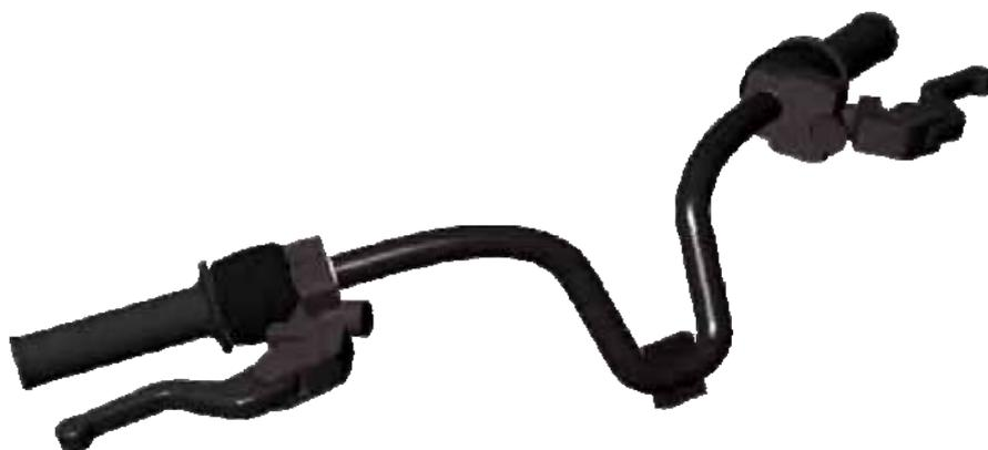
**Descrizione** Composto nella struttura da pochi pezzi essenziali è studiato per favorire l'ergonomia tipica dello scooter, l'acceleratore sulla destra e le leve del freno anteriore a destra e posteriore con frenata ripartita e recupero energia alla sinistra, impartisce al mezzo e la facilità di guida di un mezzo adatto all'utilizzo urbano
