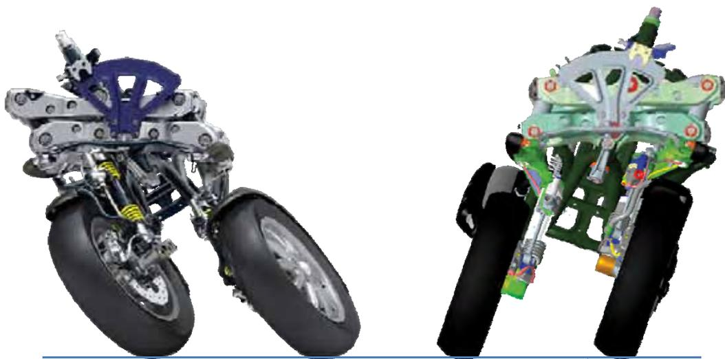
Elaborazioni Cad sulla base delle misure raccolte dai dati estrapolati dalla componentistica acquisita e primi esperimenti formali di dimensionamento in base alla geometria disegnata sugli schizzi 2D e prove ergonomiche simulate inserendo dei manichini all' interno delle geometrie disegnate.
