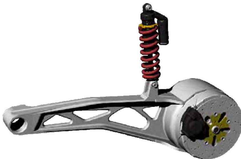
**Descrizione** Il blocco del forcellone posteriore contiene il motore da 5 kW ed è progettato per essere leggero e allo stesso tempo esteticamente gradevole.
