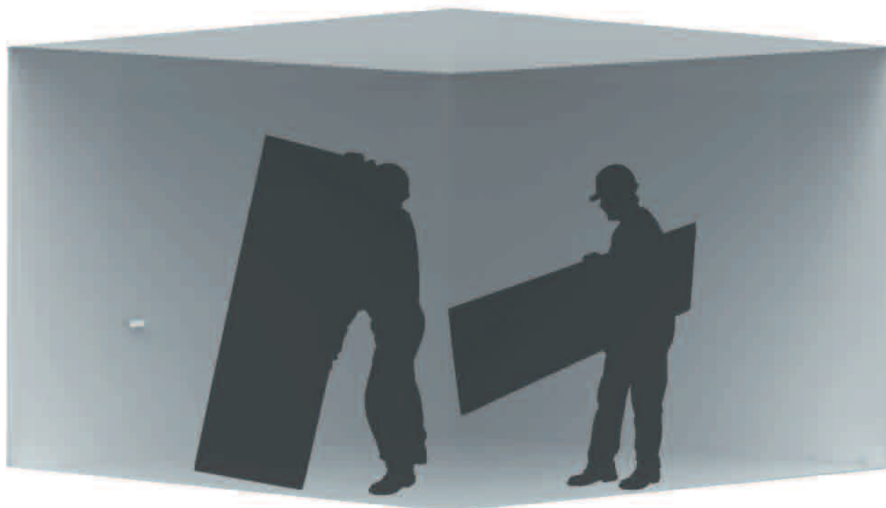
FASE 1: Camera vuota, pareti prive di qualsiasi elemento, collocazione dei vari moduli angoli verticali, a terra e a soffitto
