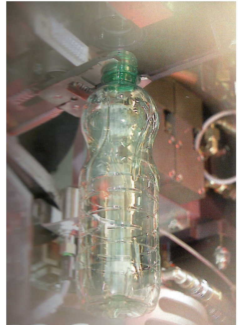
Figura 21. Bottiglia prodotta tramite processo di stretch blow moulding.
