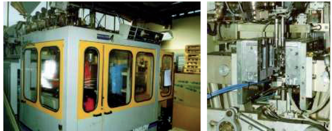
Figura 23. Macchina per estrusione soffiaggio e particolari dello stampo.
