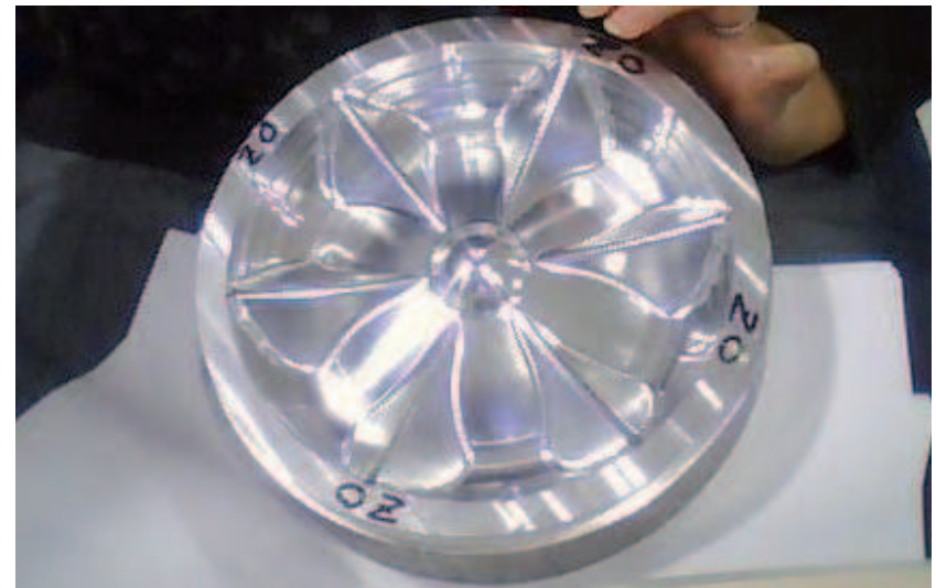
Figura 4. Fondello della bottiglia da 5 lt realizzata durante il tirocinio
