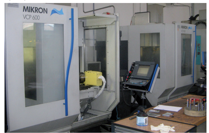
Figura 8. centri di lavoro a controllo numerico utilizzati per la realizzazione dei 2 semigusci che formano lo stampo del corpo della bottiglia.
