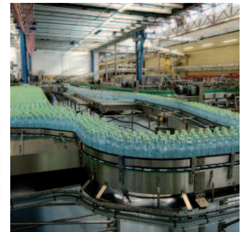
Figura 15. Riempimento di bottiglie in PET
