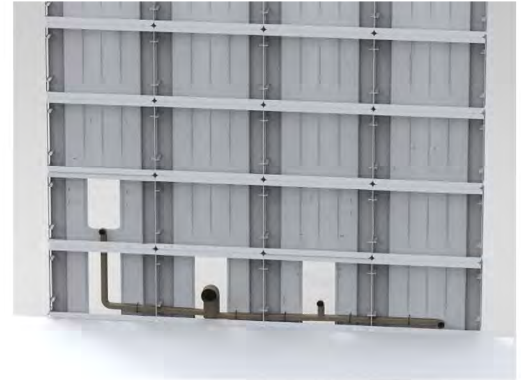
2 MONTAGGIO DEI TUBI DI SCARICO
