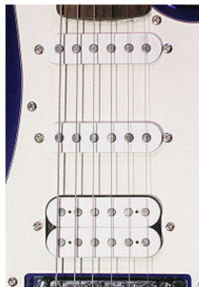
Pickup singole coil (i due in alto) e humbucker (l'ultimo in basso)
