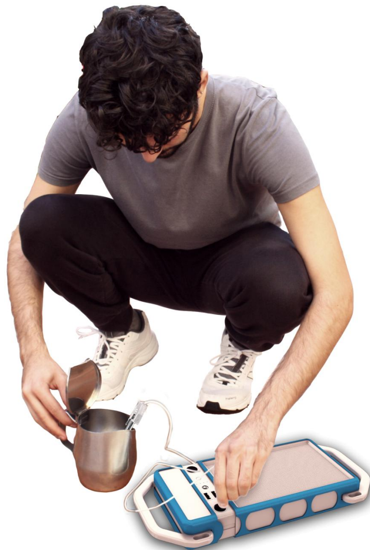
Alimentazione di una resistenza elettrica ad immersione tramite presa accendisigari da 12V
