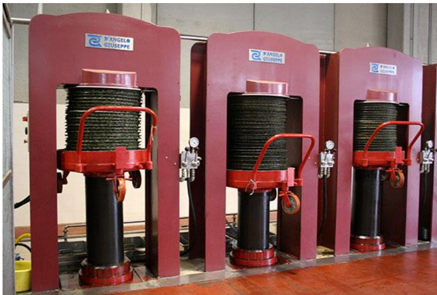
Foto 10: Friscoli nell'impianto a pressione.
