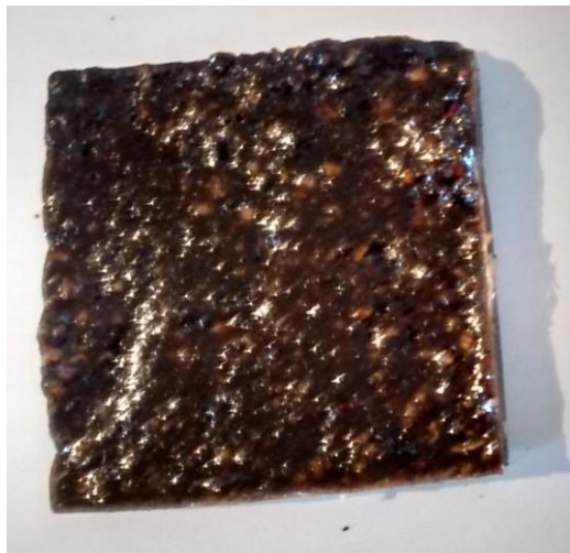
Foto 54: prova n°4 con resina poliesteri.
