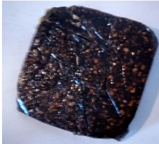
Foto 34: Resina naturale Colofonia mista resina poliesteri
