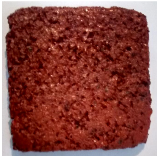
Foto 57: prova n°7 con resina poliesteri.
