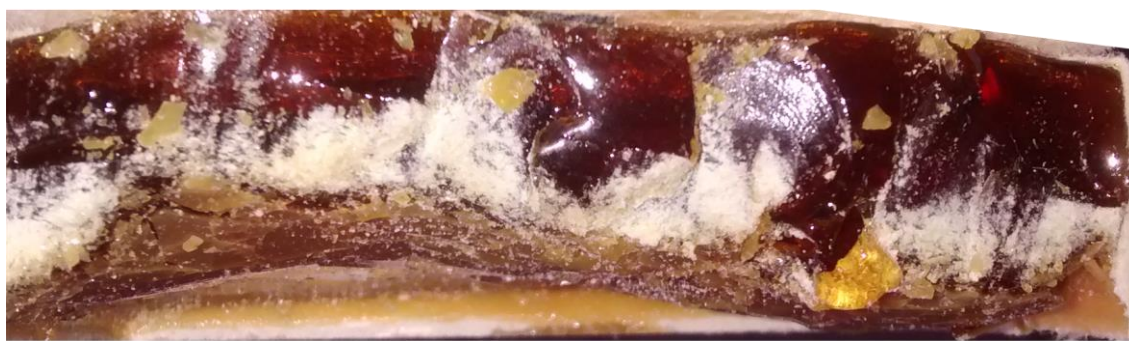
Foto 30: Resina naturale Colofonia (sezione).
