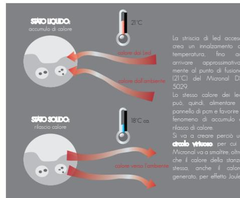
La striscia di led accesa crea un innalzamento di temperatura, fino ad arrivare approssimativamente al punto di fusione (21°C) del Micronal DS 5029. Lo stesso calore dei led può, quindi, alimentare il fenomeno di accumulo e rilascio di calore. Si va a creare perciò un **circolo virtuoso** per cui il Micronal va a smaltire, oltre che il calore della stanza stessa, anche il calore generato, per effetto Joule.
