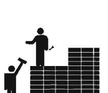
quando il muro si alza continuare la costruzione con una persona a cavallo di esso e una seconda da terra che passi i mattoni
