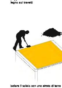
isolare il solaio con uno strato di terra in seguito battuta
