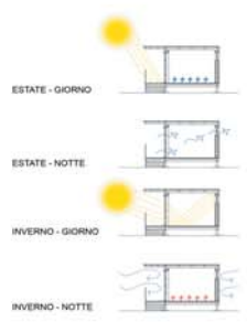
SISTEMA SOLARE PASSIVO SCHEMA DI FUNZIONAMENTO
