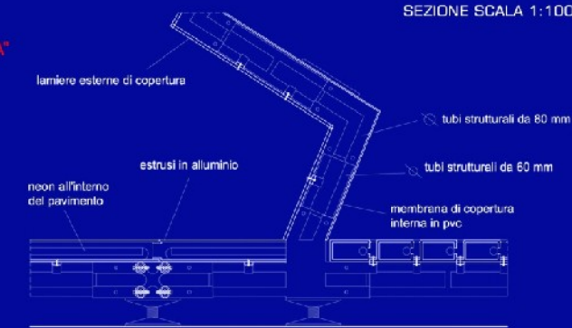
PARTICOLARE GABBIA STRUTTURALE E PAVIMENTI SCALA 1:10
