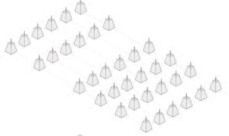
2. montaggio dei dispositivi di sostegno
