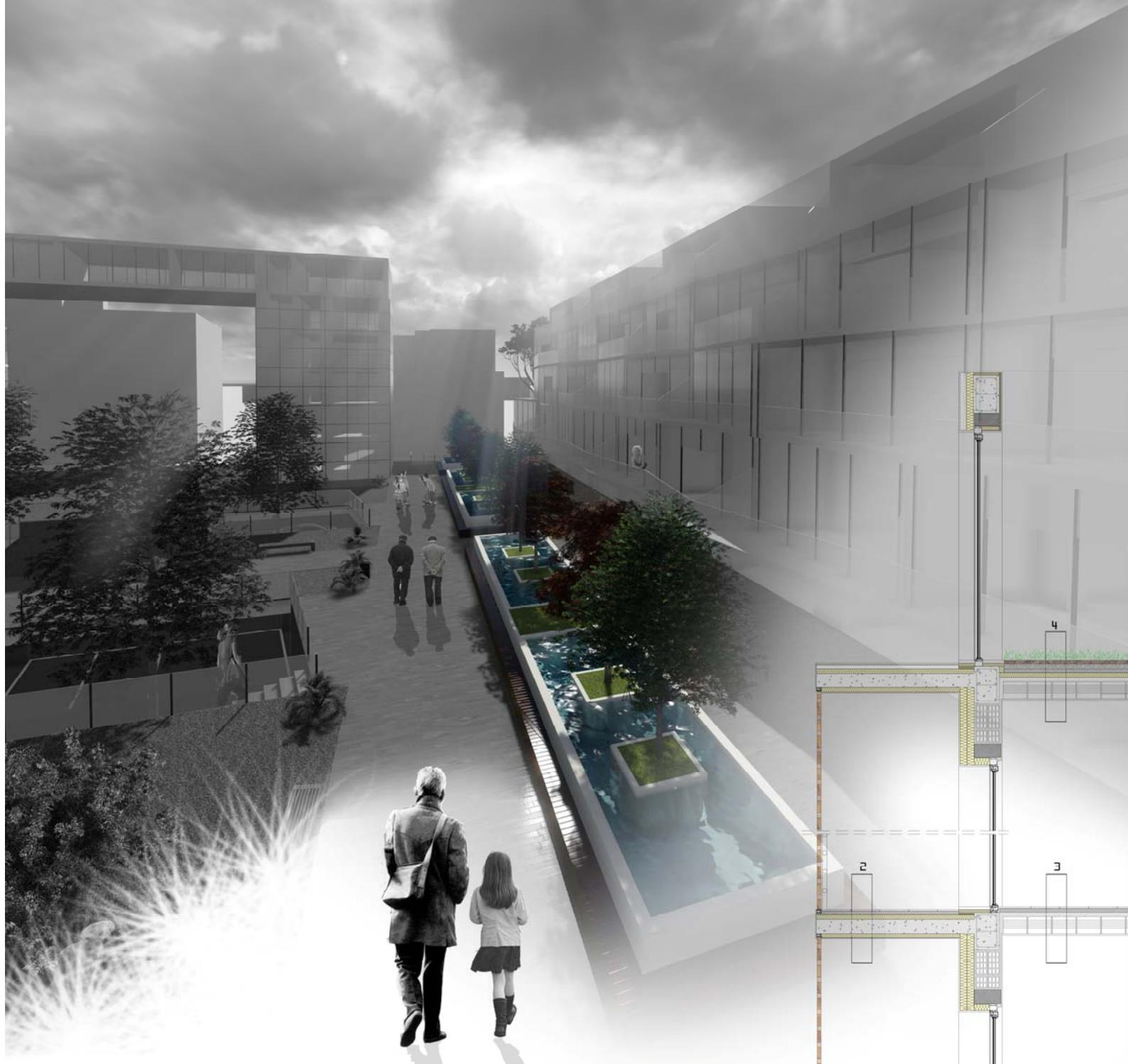
1: Intonaco esterno a base di calce naturale sp. 1.5 cm, due pannelli termoisolanti naturali sp. 6 cm (densità 140 kg/m<sup>3</sup>) + 6 cm (densità 140 kg/m<sup>3</sup>), bio-mattoni forati 12x25x25 cm, intonaco interno a base di calce naturale sp. 1.5 cm
