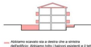
Abbiamo scavato sia a destra che a sinistra dell'edificio, Abbiamo tolto i balconi esistenti e il tetto.
