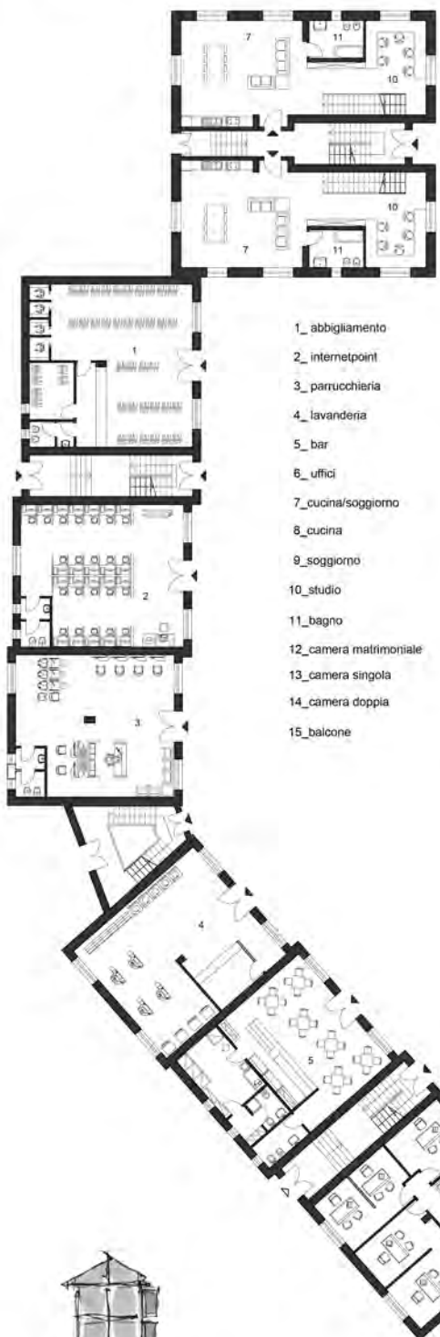
PIANTA PIANO TERRA SCALA 1:200
