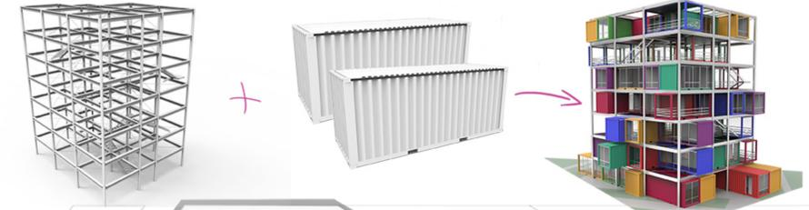
Il progetto è stato pensato in modo da utilizzare una struttura a vista con pilastri circolari di diametro 30 cm con travi HEB 360, in modo da permettere una certa libertà di inserire o togliere i container in base all'esigenza. Un edificio che, nonostante la rigidità della struttura e la geometria dei container, crea una visione dinamica data dal colore e dall'irregolarità di inserimento.
