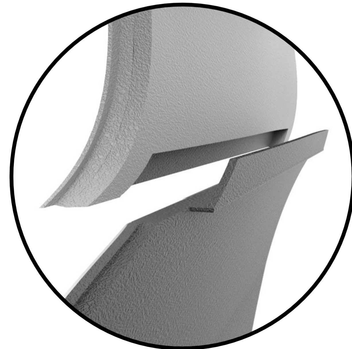
4. INCASTRO SCOCCA MOBILE MODULO CENTRALE LATERALE 50cm CON SCOCCA MOBILE MODULO INFERIORE LATERALE 50cm
