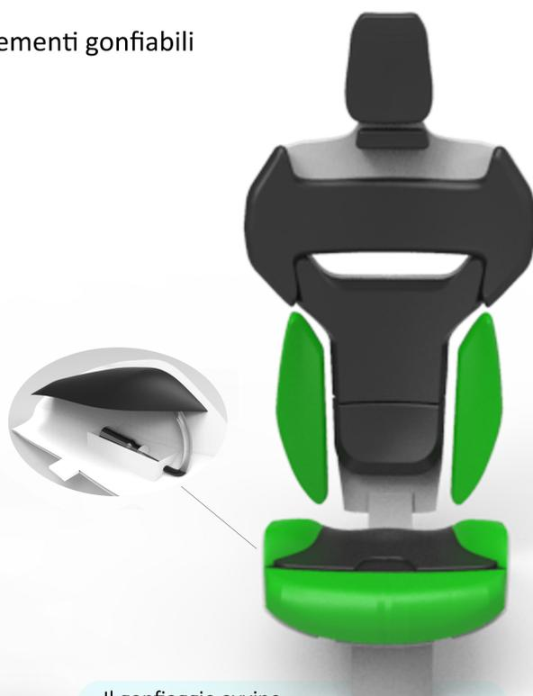
Il gonfiaggio avviene tramite una bombola di aria compressa di piccole dimensioni situata nella parte laterale della seduta del sedile che attivandola spinge aria nel cuscinetto in butile. La regolazione del gonfiaggio avviene interagendo tramite le interfacce situate sul cruscotto.
