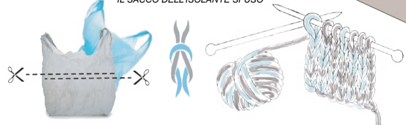
AUTOCOSTRUZIONE DEL TELO PER IL SACCO DELL'ISOLANTE SFUSO
