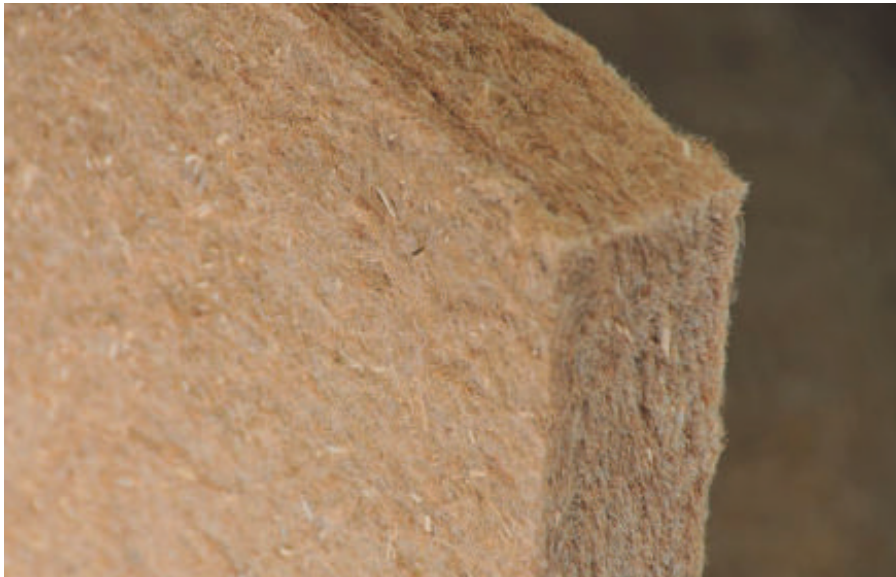
Pannello termoacustico in fibra di canapa
