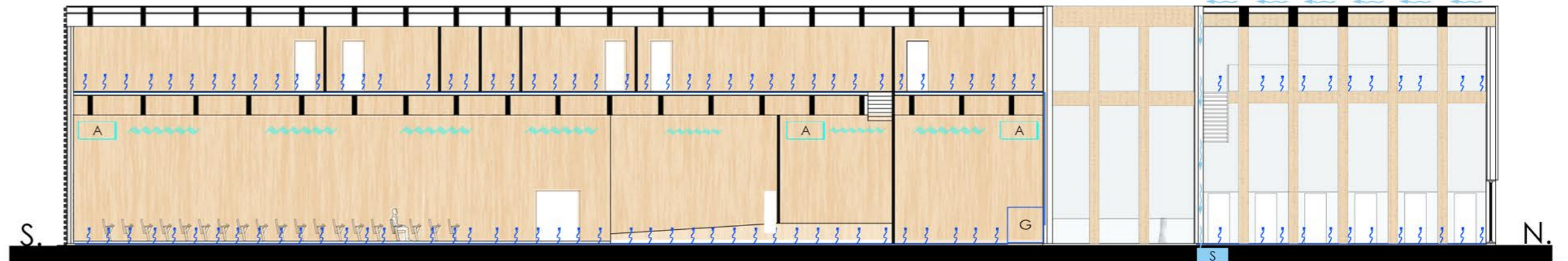
SEZIONE A-A' 21 GIUGNO VENTILAZIONE FORZATA ALL'INTERNO DEI LOCALI TECNICI, BACKSTAGE E TEATRO ATTRAVERSO IL PAVIMENTO GALLEGGIANTE AVVIENE LA RACCOLTA DELLE ACQUE PIOVANE
