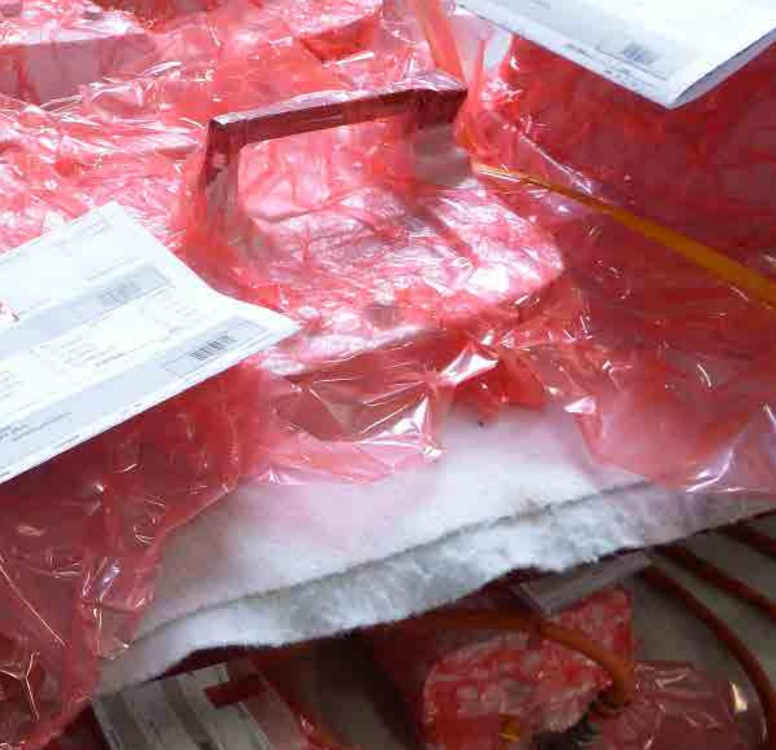
Kit di lavorazione in fase di preaspirazione per la preparazione del ciclo di cura in autoclave con annesso OdL. Foto: Niccolò Colafemmina.
