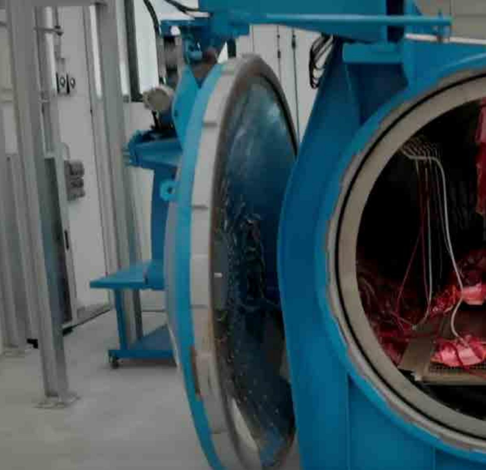
Autoclave con parti pronte per la cura. Foto: HP Composites.
