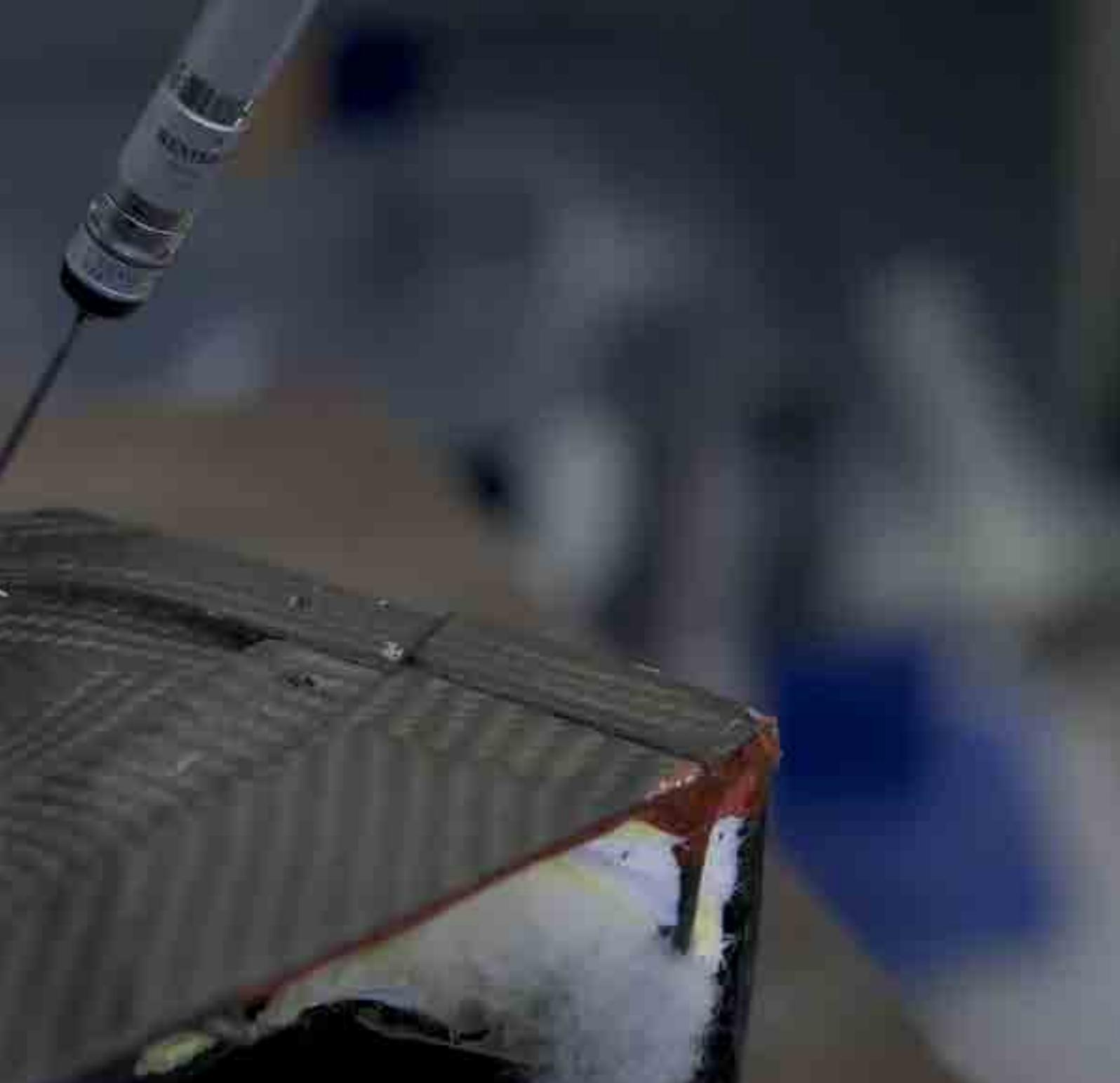
Analisi dimensionale attraverso un tastatore digitale. Foto: HP Composites.
