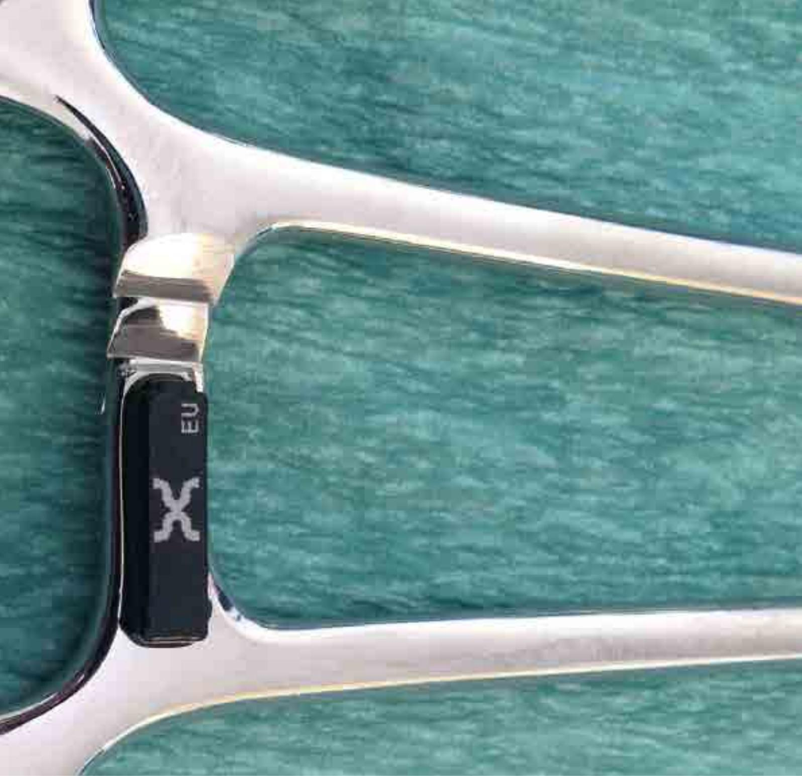
Dettaglio di un tag RFID per strumenti chirurgici. Foto: Region Hovedstaden.
