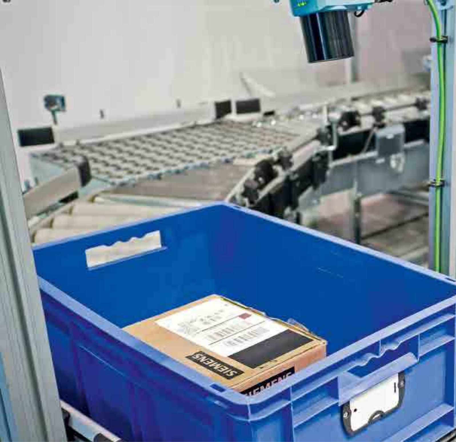
Tracciamento di un pacco attraverso un varco dotato del lettore RFID Siemens SIMATIC RFID RF system. Foto: new.siemens.com.
