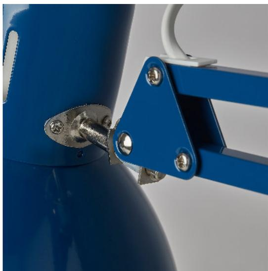
Dettaglio che rappresenta in una sola foto tutto il sistema della lampada: doppia piastra triangolare posta ai due lati per fermare i bracci del telaio, giunto snodabile avvitato al paraluce, e telaio a profilo quadrato e cavo, usato come passacavi..
