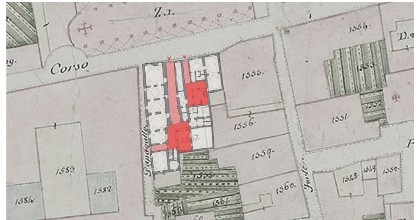
fig. 71 Lo schema evidenzia gli ingressi con gli androni e le due corti, in planimetria sono ben visibili i due assi murari centrali che segnano i confini dei due organismi autonomi originari.
