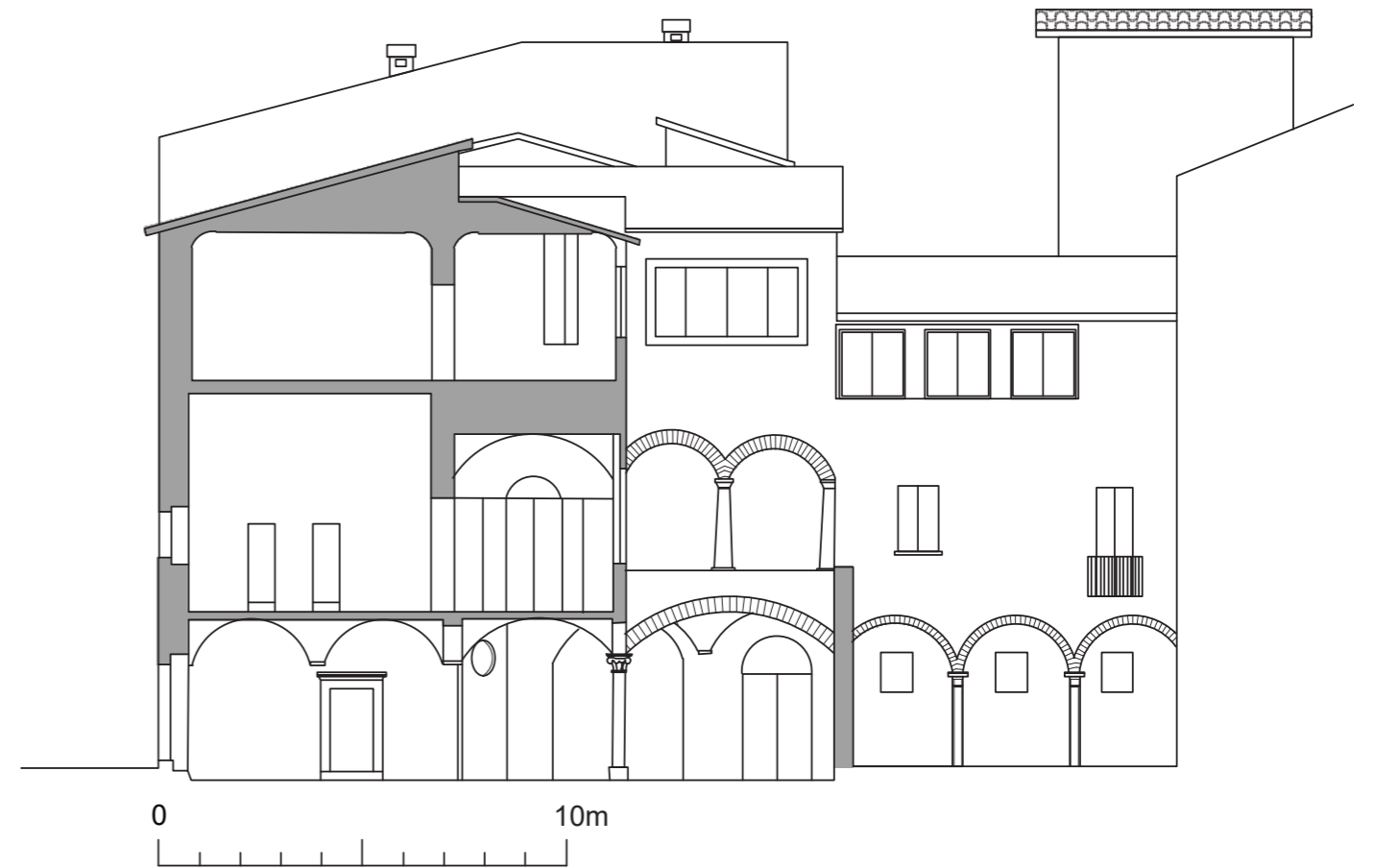
fig. 73 La sezione mostra il cortile ovest con lo spazio del giardino e gli archi tamponati.
