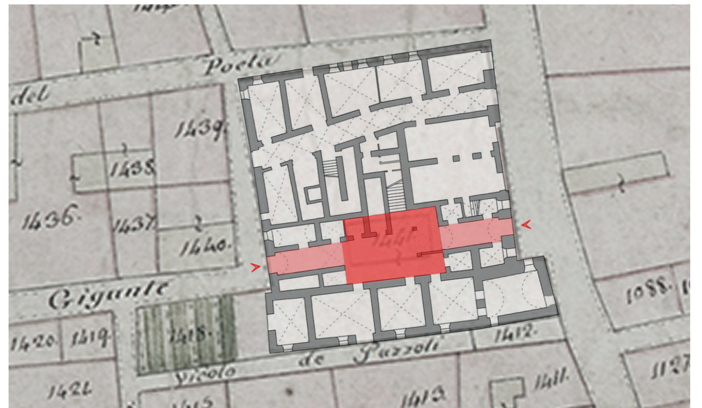
fig. 33 Lo schema in planimetria evidenzia gli ingressi con i due androni assiali e la corte loggiata collocata nella parte sud del palazzo.
