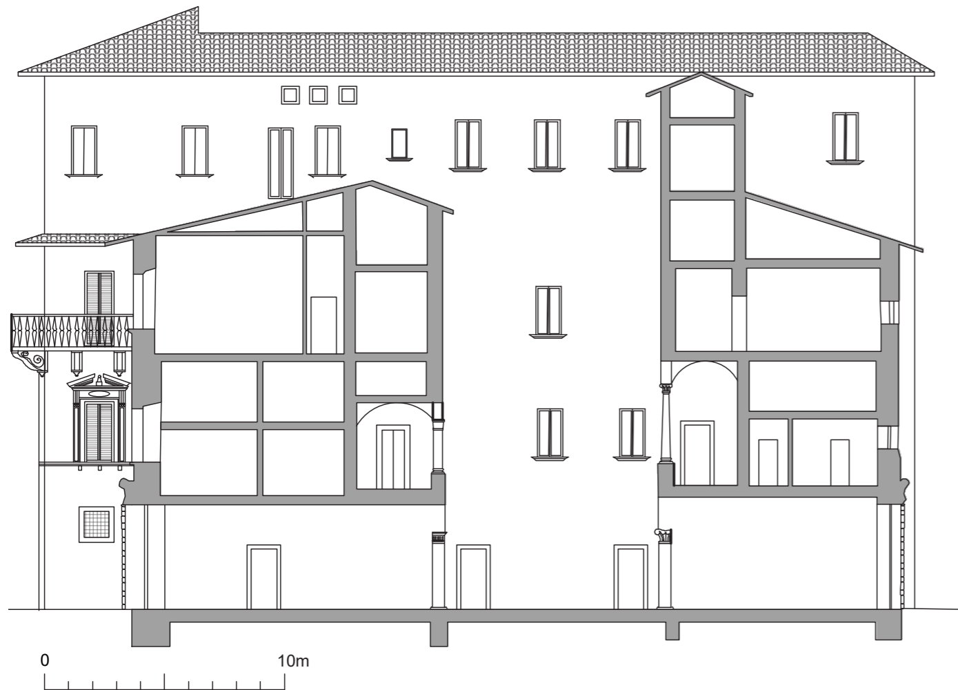
fig. 34 Disegno della sezione trasversale agli ingressi. Si notano le due ali con altezze differenti.
