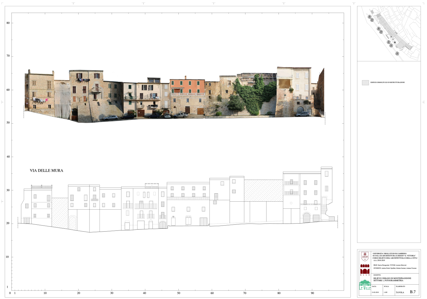
RILIEVO DELL'ARCHITETTURA E DELLA CITA' _ PROF.SSA ENRICA PIERAGOSTINI_ 13/02/19 (Rilievo della città di Monteprandone_ in foto abbiamo la fotogrammetria dei fronti e la riproduzione con Autocad degli stessi)
