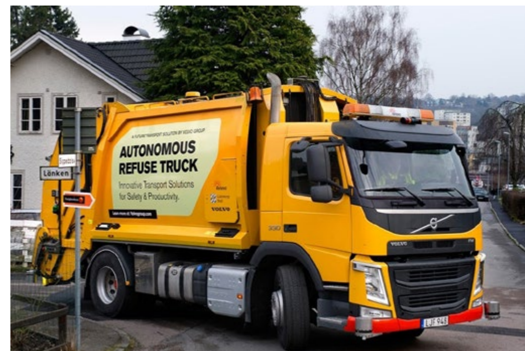
Camion della spazzatura in fase di Test da parte dell'azienda Volvo. Il veicolo si guida da solo e recupera i cassonetti ai bordi delle strade.
