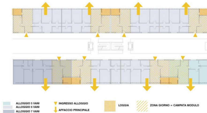
Figura Stralcio di pianta del piano VII Trancia F – Corpo I di Corviale: schema esemplificativo della distribuzione degli alloggi in base al numero di vani.
