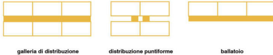
Fig. 42 Schemi esemplificativi sistemi di distribuzione tipologia in linea.
