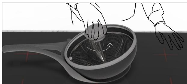
Il pomello del coperchio serve a dare la carica al perno attraverso il caricamento antiorario del timer, che aziona il movimento. Un giro completo permette una rotazione di 2 minuti.
