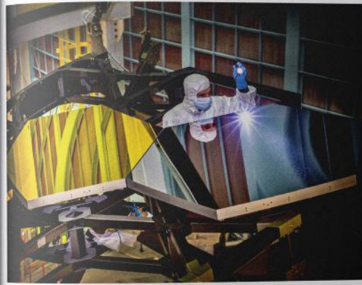
Fig. 34 Due parti dello specchio del telescopio. L'operatore sta analizzando la superficie della specchio prima della placcatura in oro.
