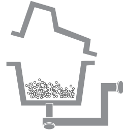
Fase 1 : caricamento del materiale in granuli di HDPE
