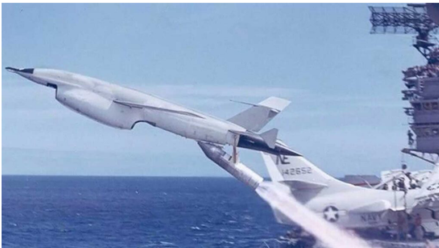
Lightning Bug modello 147SK, modificato per essere lanciato da una nave al largo
