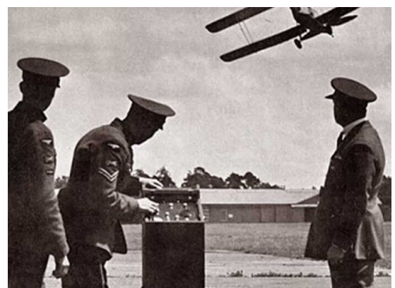
Sistema di controllo a terra del Queen Bee
