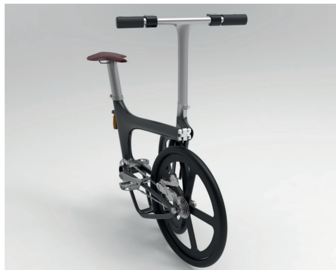
2. Sganciare l'ammortizzatore e ruotare il triangolo
