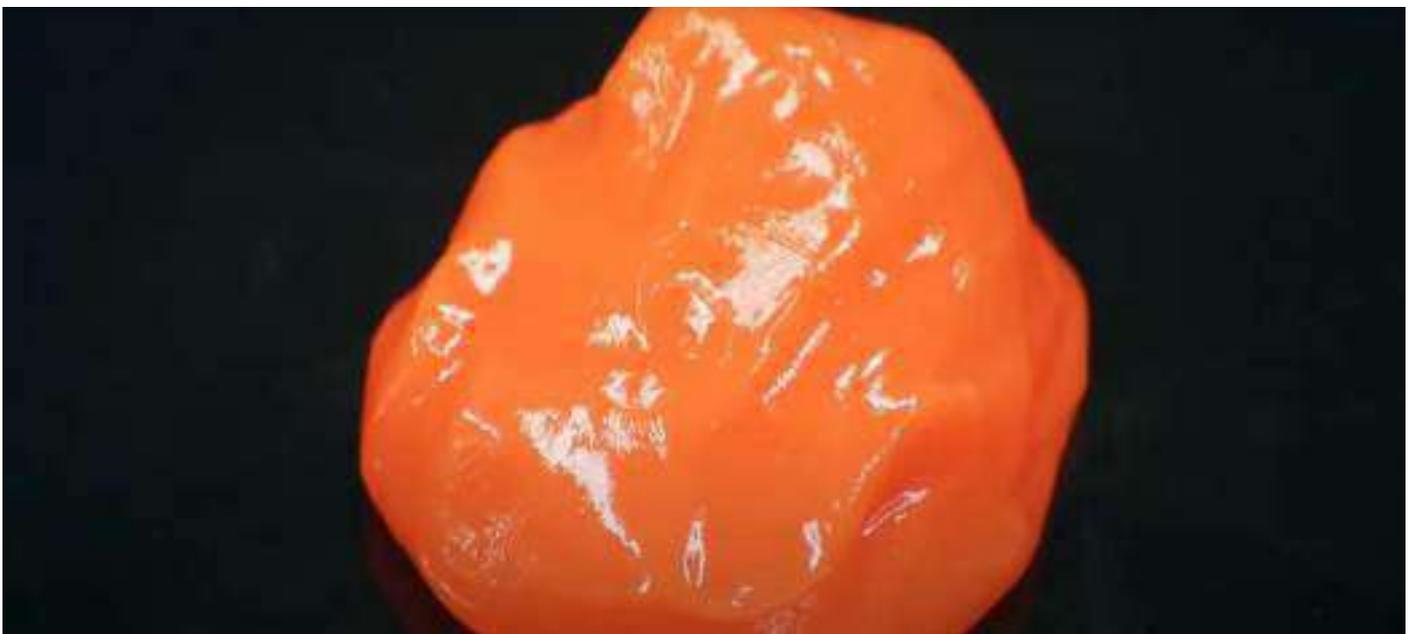
Il **d3o** è un **materiale dilatante** (cioè un fluido non newtoniano in cui la **viscosità aumenta all'aumentare della velocità di deformazione**) composto da polimeri elastomerici. Si presenta come un gel o una gomma malleabile arancione se non sottoposto a sforzi elevati.
