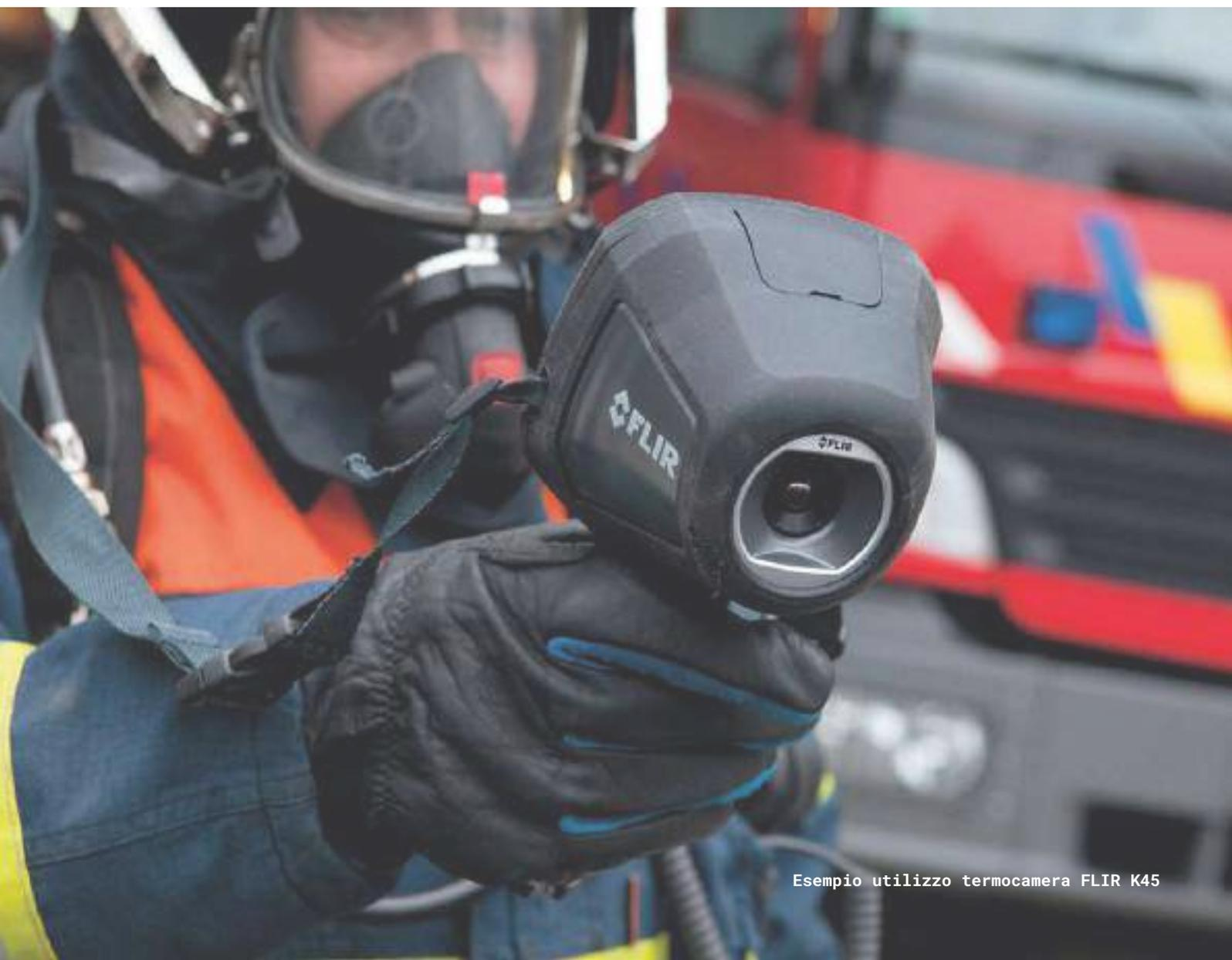
Esempio utilizzo termocamera FLIR K45
