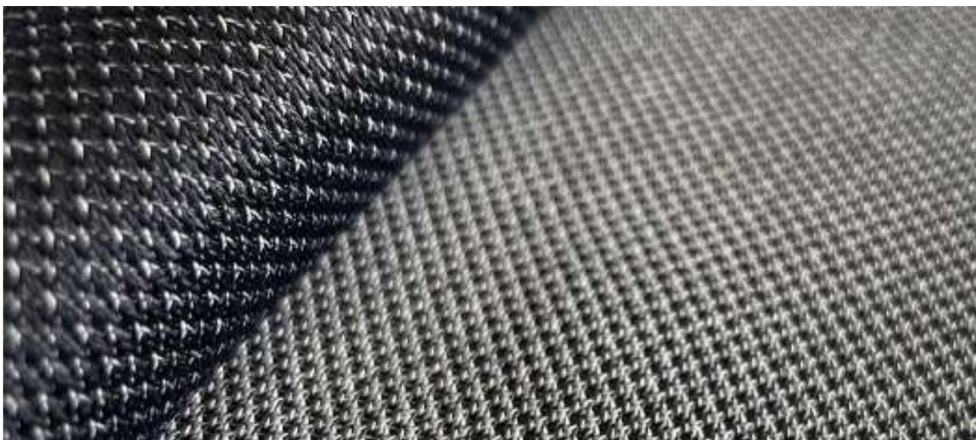
Il **tessuto tecnico NOMEX®** è realizzato con il filato **para-aramidico ad alte prestazioni**. Conferendo prestazioni ben bilanciate in termini di proprietà meccaniche, resistenza chimica e stabilità termica, il filato, permette la realizzazione di tessuti tecnici molto performanti dalle proprietà fisiche e tecniche notevoli.
