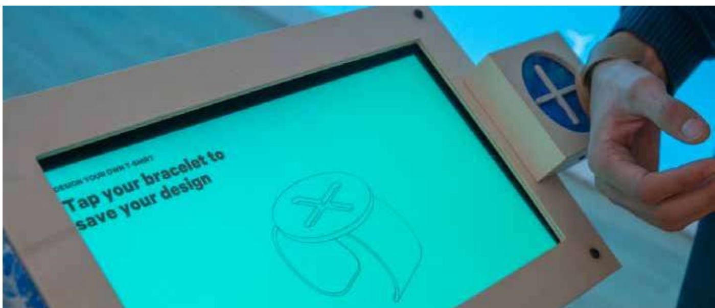
Braccialetto abilitato per RFID che può essere utilizzato per interagire con le stazioni di azione.
