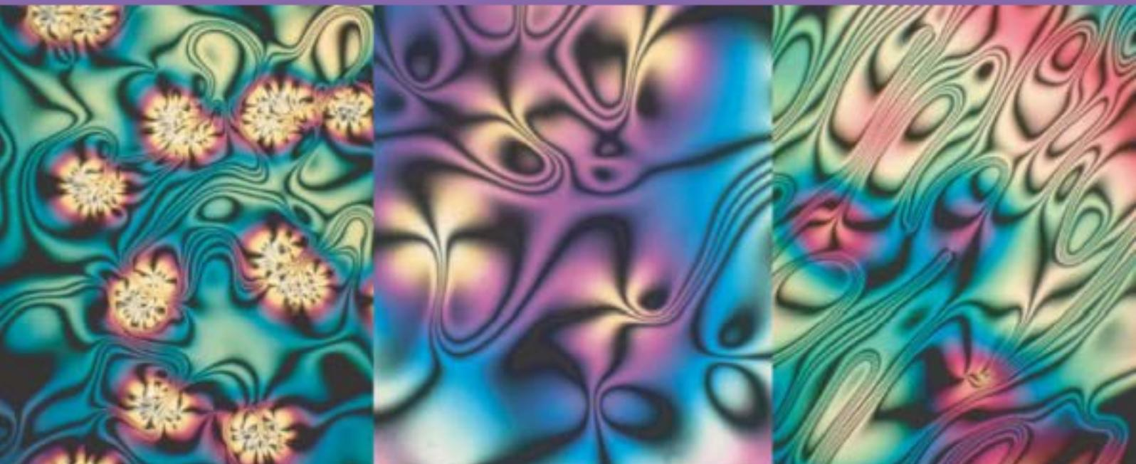
Progressivo cambio di fase di film a cristalli liquidi (tipici utilizzati negli LCD).
