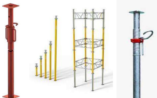
Per sostenere una struttura dalla statica incerta si può ricorrere anche ai Puntelli; l'azione dei puntelli è infatti volta essenzialmente a fronteggiare il dissesto da traslazione verticale o/e orizzontale o a sostenere una struttura non ancora ultimata.
