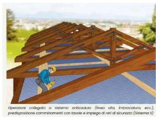
*Operatore collegato a sistema anticaduta (linea vita, imbroccatura, ecc.), predisposizione camminamenti con tavole e impiego di reti di sicurezza (Sistema S)*
