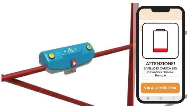
**15.B)** Se il livello di carica non è sufficiente, il preposto viene avvertito tramite l'App per la sostituzione della batteria.
