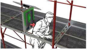
11.A) Se in questi 10 secondi il sensore rileva il passaggio di un altro lavoratore, il timer si ferma. Quando il sensore non rileva più la presenza del lavoratore, il timer riparte.
