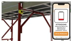
6.B) Se il livello di carica non è sufficiente, il preposto viene avvertito tramite l'App per la sostituzione della batteria.
