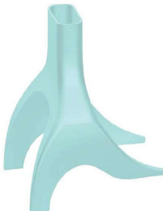
Il corpo di SkateBuddy è realizzato attraverso la piegatura di una lamiera di acciaio di uno spessore di 5mm, che viene successivamente lavorata e forata per la regolazione delle altezze.
