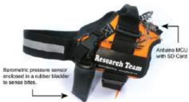
▲ Sensore di pressione barometrica racchiuso in un involucro di gomma applicato al giubbotto
