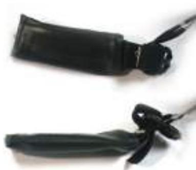
▲ Sensore di pressione barometrica racchiuso in un involucro di gomma
