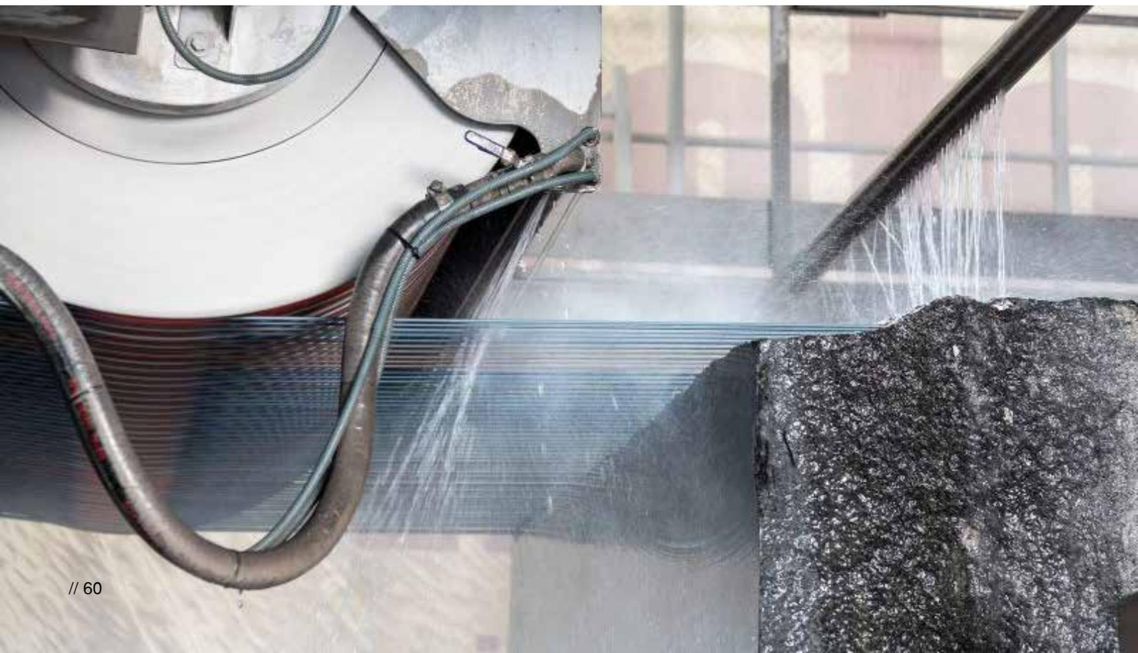
dimensioni inferiori, il ciclo prevede che subiscano un trattamento di superficie (levigatura, lucidatura, bocciardatura) e che successivamente siano tagliate a misura, ed infine siano sottoposte ad eventuali finiture aggiuntive (lavorazioni sulle coste, foratura, profilatura dei bordi).
