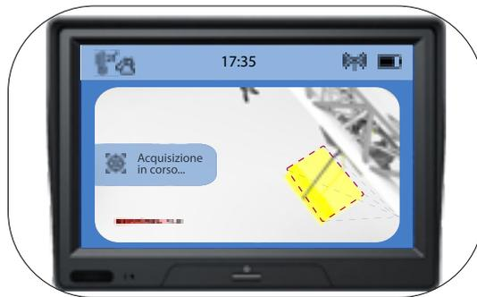
Dal display è possibile tenere sotto controllo l'acquisizione della sagoma del carico sospeso.
