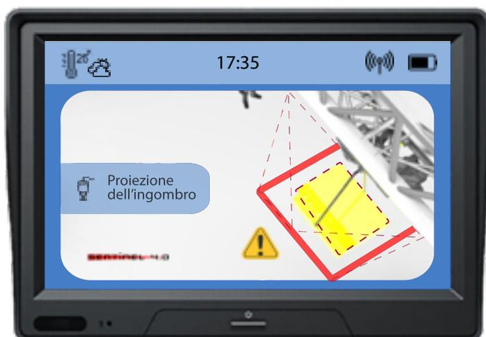
A seguito dell'acquisizione dell'ingombro entrambi i dispositivi del sistema Sentinel 4.0 restituiscono, grazie ad un'opportuno apparato di collimazione galvanometrica, una proiezione luminosa di colore rosso visibile a terra dell'area entro la quale non è consigliato avvicinarsi o transitare per ragioni di sicurezza. Inoltre l'area di sicurezza proiettata risulta più ampia dell'ingombro acquisito.
