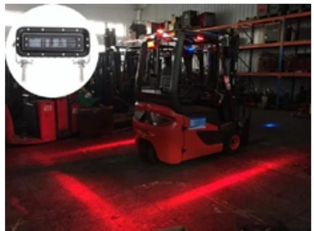
Safety bar significa letteralmente “barriera di sicurezza”. Non sono altro che chiari segnali luminosi proiettati da un faretto, fissato al muletto sulla parte alta del montante.
