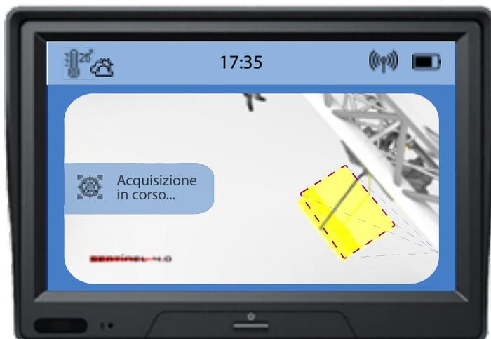
In caso di necessità è possibile attivare l'acquisizione dell'ingombro del carico tramite apposito comando da fornire tramite il radiocomando. Il sistema intelligente implementato al sistema di sorveglianza identifica la sagoma del grave per poi elaborare i risultati della scansione e generare una pattern morfologico preimpostato da proiettare a terra.
