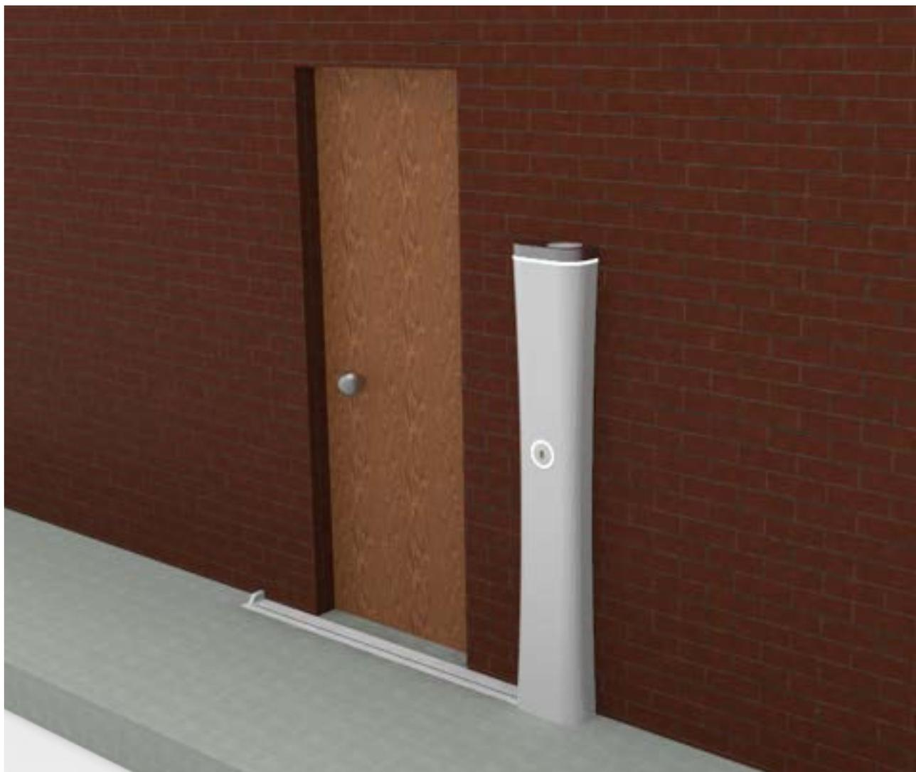
Il dispositivo come illustrato in figura presenta due led di segnalazione, il primo nella parte superiore ed il secondo intorno alla serratura. Questi hanno la funzione di dare un segnale ridondante dello stato del dispositivo.
