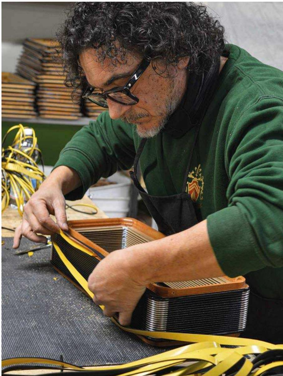
Assemblaggio componenti del mantice. (Scandalli Accordions)
