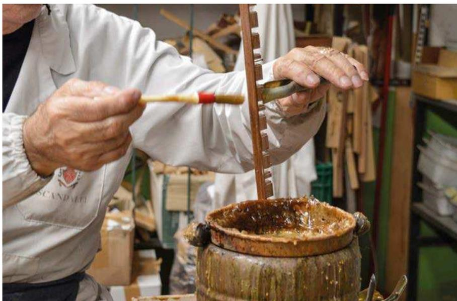
Stesura della colla in un componente della tastiera a piano. (Scandalli Accordions)
