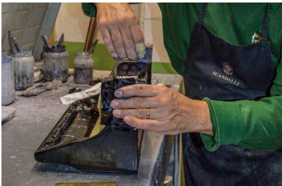
Incollaggio della celluloido con pressino per evitare la formazione di bolle d'aria. (Scandalli Accordions)
