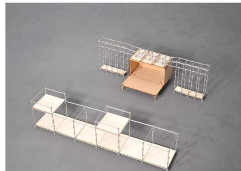
Fase 7: Si aggiungono i pannelli ORGANOID che fungono da pavimentazione
