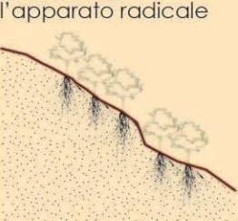
Plantazione arborea per il consolidamento dei suoli tramite l'apparato radicale
