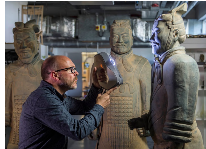
Lincoln Conservation, ricostruzione di una testa mancante per una collezione di tre guerrieri di terracotta utilizzando scansione 3D, stampa 3D e tradizionali tecniche di restauro
